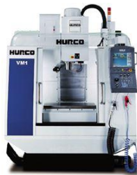
Hurco VM1 X-Achse 760 mm, Y-Achse 360 mm, Z-Achse 520 mm Steuerung Hurco UltiMax
