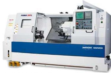
Dosan Puma 300M Mit angetriebenen Werkzeugen Drehen bis \varnothing 360 mm x 600 mm Länge, Stangendurchlass \varnothing 40 mm Fanuc Steuerung
