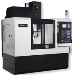
CamPro Smart 2 Mit 4-Achse und Schwenkbrücke X: 750 mm, Y: 430 mm, Z: 450 mm Mit 4 Achsen symultan und Schwenkbrücke Eilgang 48 m/min Mitsubishi Steuerung mit NaviMill M70
